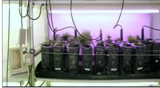
Fig. 1 Ensayo en sustrato con control de riego por sondas TDR
