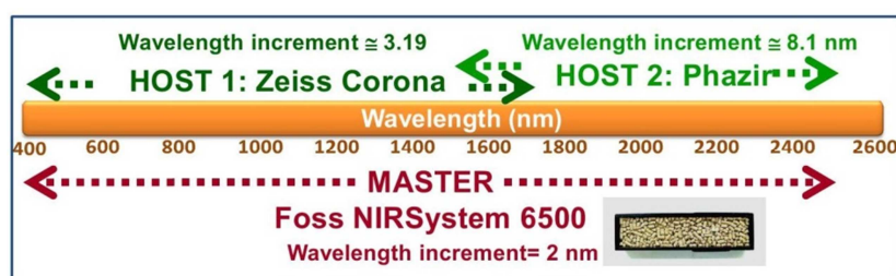
Figura 1. Escalas de absorción y rango de las longitudes de onda en los instrumentos utilizados: Foss NIRSystems 6500 SY-II (Master- at-line): rango de trabajo 400- 2500nm. Zeiss Corona vis-NIR1.5: rango de trabajo 302- 1711nm. Phazir 1624, Polychromix Inc.: rango de trabajo 1600-2400 nm.
