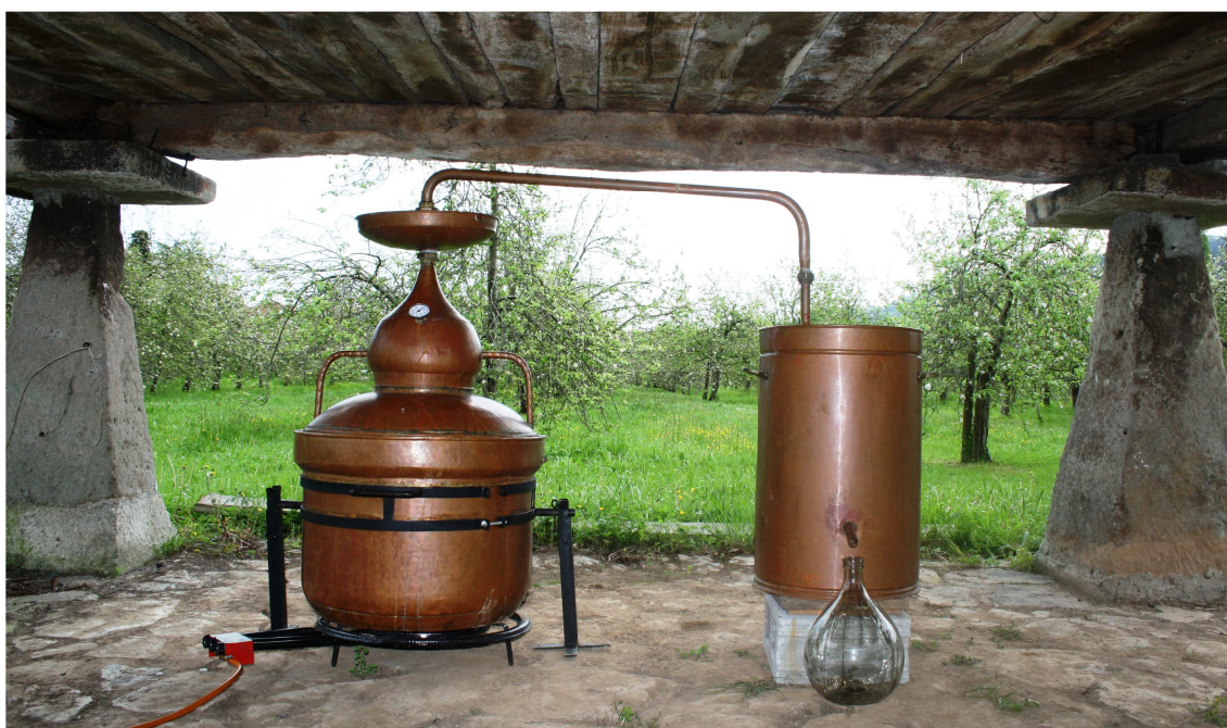
Alambique charentés con lente de rectificación
