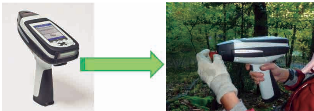
← Figura 4. -Equipo NIRS, MicroPHAZIR™ Handheld NIR Analyzer para análisis in-situ .
