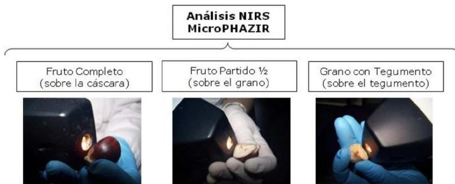
**Figura 2.** Esquema del diseño experimental para análisis NIRS con el equipo portátil MicroPHAZIR™
