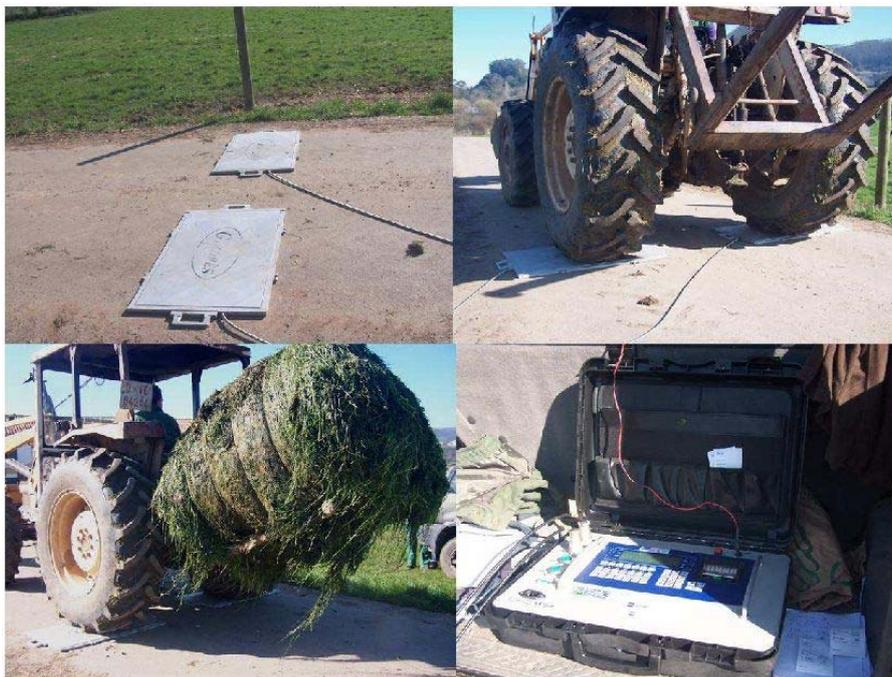
**Figura 1. Procedimiento para el cálculo real de la producción de forrajes utilizando una plataforma de pesada móvil**
