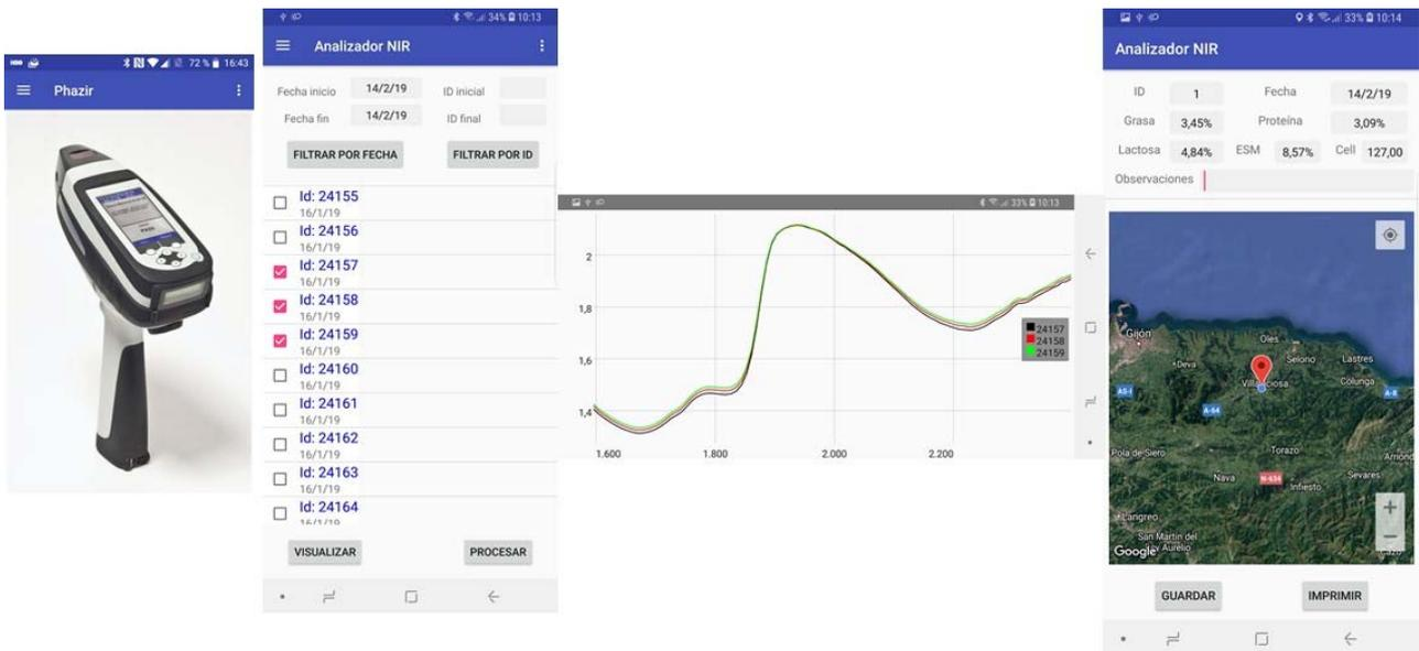
**Figura 2. Información de pantalla con identificación de muestras, visualización de espectros de leche, resultados analíticos NIRS y geolocalización de la explotación**
