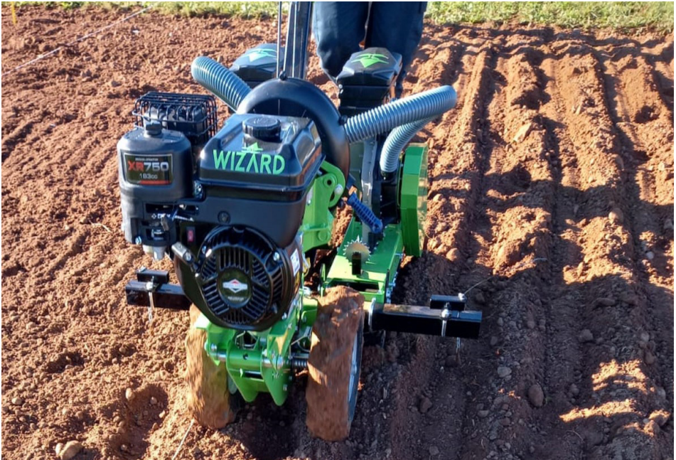
Imagen 1. Sembradora neumática autopropulsada con dos líneas de siembra regulables
