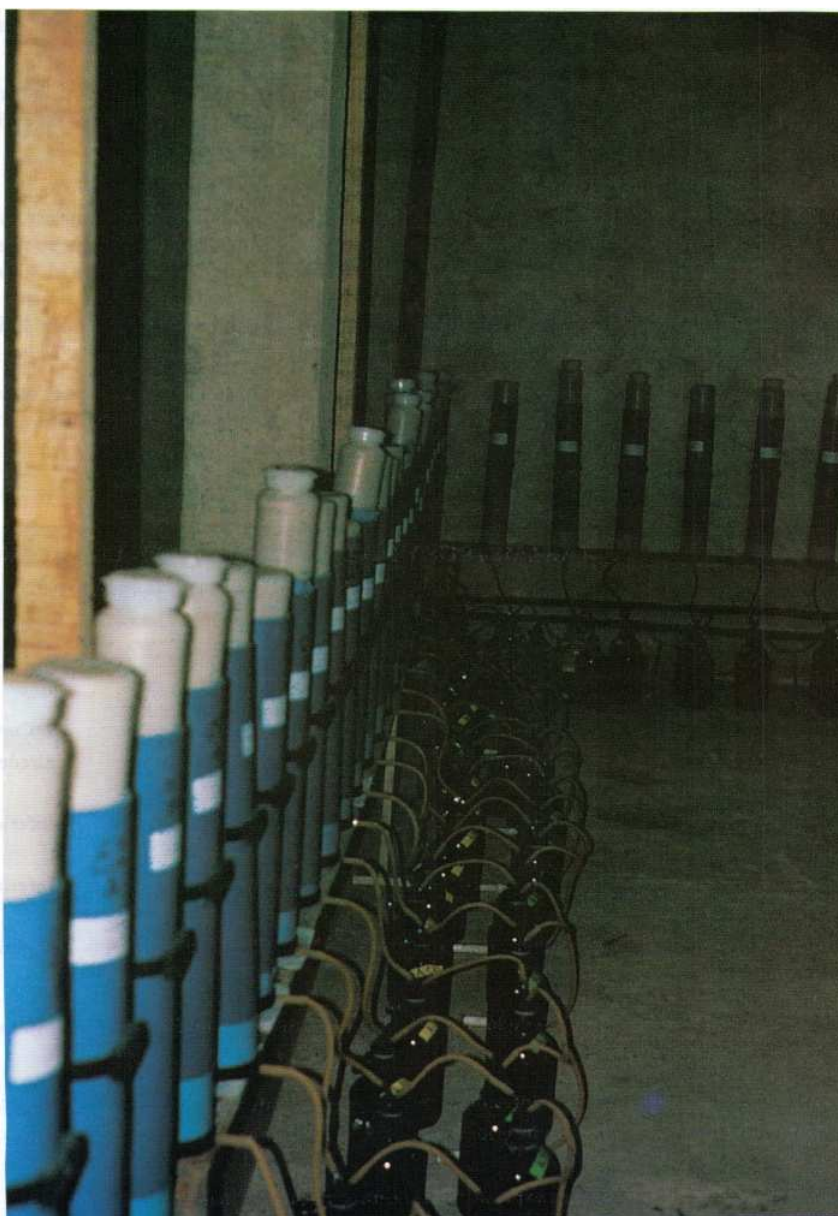
Microsilos experimentales de laboratorio para testaje de aditivos.
