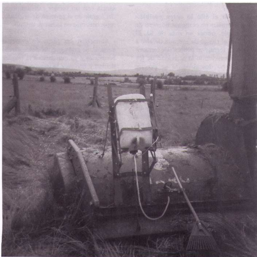
Aplicador de ácido fórmico instalado en una cosechadora-picadora.
