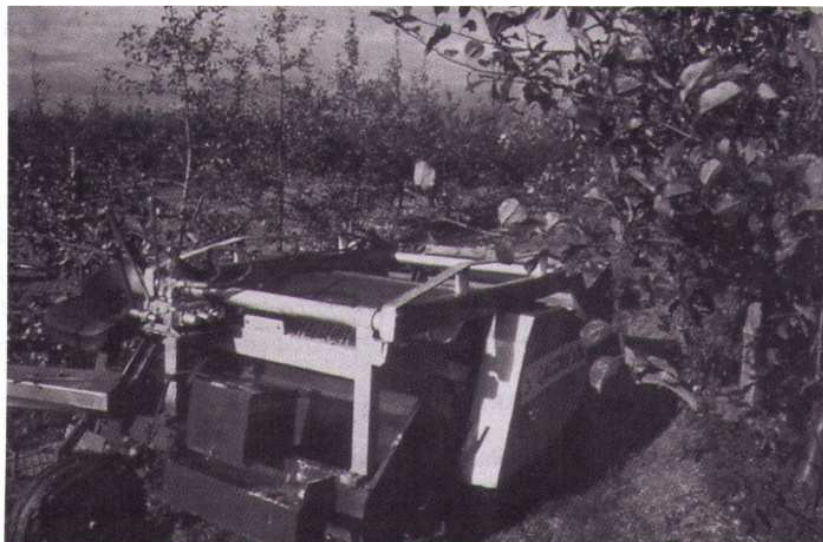
Máquina recolectora de manzano de sidra
